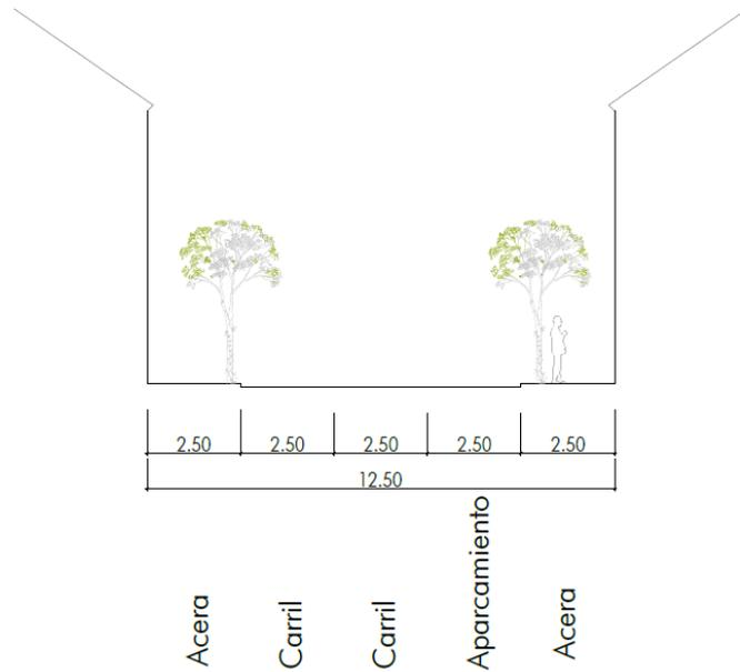
Calle de nueva creación. Sección tipo para doble dirección.
